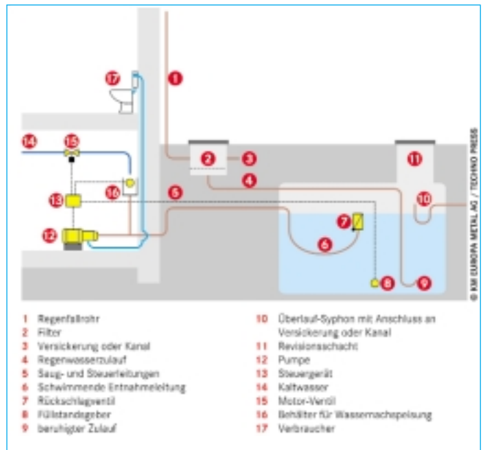
Funktionsschema einer Regenwassernutzungsanlage
