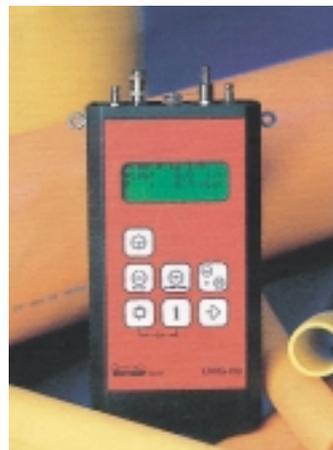
eingesetzt werden können. Je nach Meßergebnis sollte eine uneingeschränkte Gebrauchsfähigkeit festgestellt werden, oder die Leckstelle muß geortet und anschließend saniert werden. Das LMG-03 soll bis zu 30 Meßergebnisse speichern und
