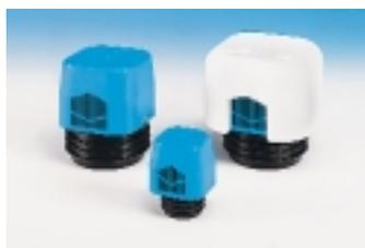
(DN 32 bis DN 50 und für DN 70 bis DN 100) lieferbaren Belüfter sollen sich zur Belüftung von Entwässerungsleitungen in Ein- und Zweifamilienhäusern eignen. Vorausgesetzt wird jedoch, daß bei Einfamilienhäusern wenigstens eine Fallleitung zur Entlüftung über das Dach geführt wird. Bei Reihenhäusern muß die Abwasserleitung zudem an einer Sammelleitung angeschlossen sein, und die Gebäude dürfen nicht mehr als drei Vollgeschosse haben.
