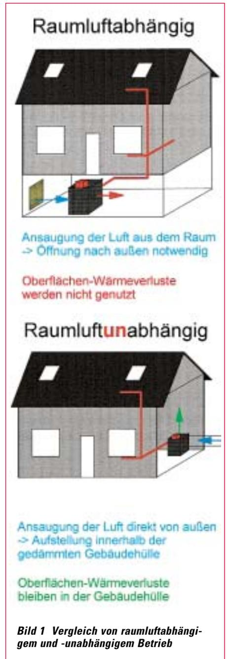
**Bild 1 Vergleich von raumluftabhängigem und -unabhängigem Betrieb**
