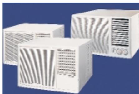
Komfort Raumklimageräte. Je nach Gerätetyp beträgt die Kühlleistung 2140, 2540 oder 3280 W. Durch ein ausziehbares Chassis können die Modelle in Fenster oder Außenwände eingebaut werden. Die Regelung der Raumtemperatur erfolgt über die eingebauten Schalter und einem integrierten Thermostaten.
