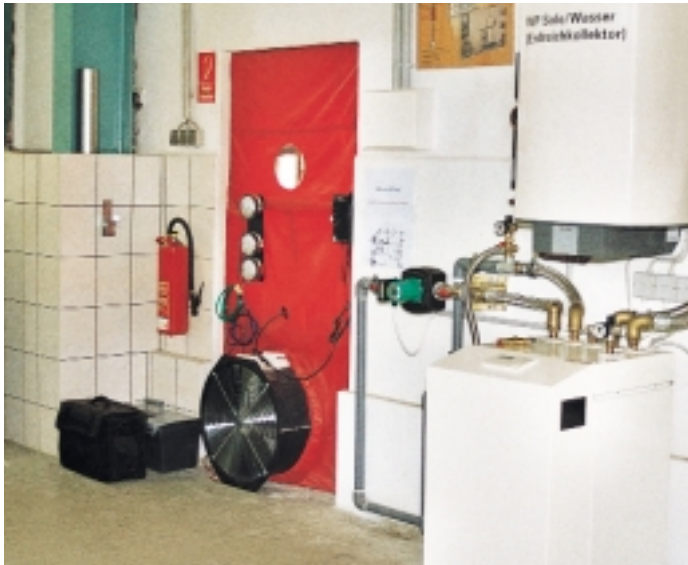
Neben verschiedenen Energiesystemen findet auch das Blower Door Meßverfahren hier seinen Platz
