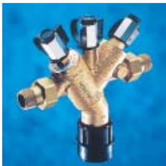
derer und ein Abflußventil unterteilen den Systemtrenner in drei Kammern mit unterschiedlichen Druckzonen. Das unkontrollierte Öffnen des Abflußventils soll dadurch vermieden werden. Zudem ist die gesamte Architektur des Geräts so konzipiert, daß in keiner Betriebsphase Wasser stagnieren und verkeimen kann. Das Kartuschensystem wird durch einen integrierten Edelstahl siebeinsatz sowie die An-
