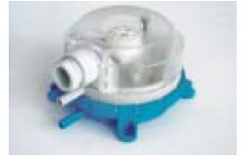
20 bis 2500 Pa in der höchsten Version auf 1000 bis 4000 Pa erweitert worden. Als Standardausführung können bis 1 A bei 250 VAC und in der Schwachstromvariante 0,1 A bei 24 VDC geschaltet werden. AMP-Flachstecker 6,3 x 0,8 nach DIN 4622 oder alternativ aufsteckbare Schraubklemmen stellen die elektrische Verbindung her. Die Stutzen des Druckanschlusses sind für 6-mm-Schläuche vorgesehen.
