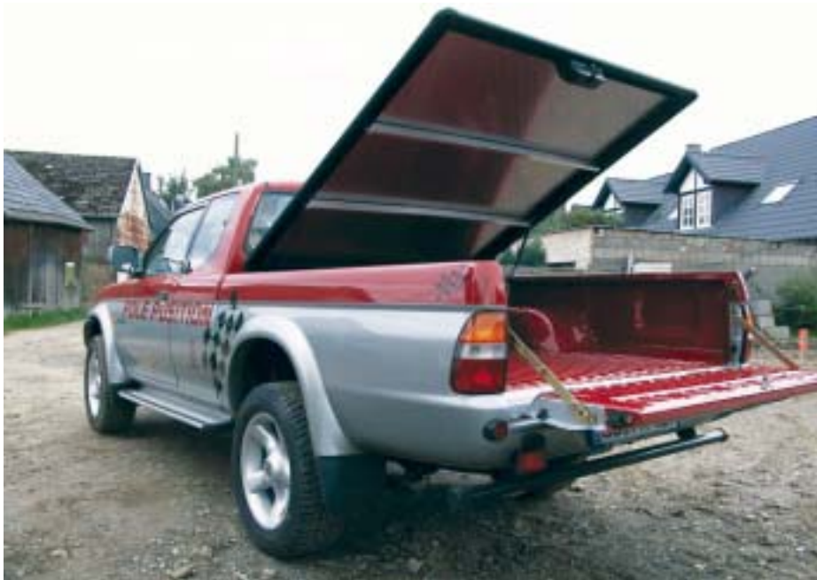
Sicher verstaubt: Auf der großen, kunststoffverkleideten Pritsche mit gasdruckfederunterstütztem Deckel des L200 ist Werkzeug und Material vor neugierigen Blicken, Wetter und langen Fingern geschützt
