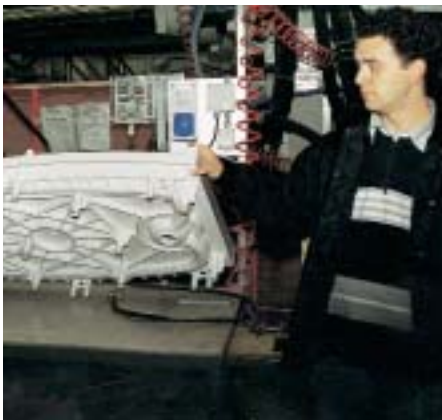
Durch die Verwendung von Kunststoffspritzguß kann z. B. bei der Zweisitz-Duschkabine „Next 140“ auf eine zusätzliche Verstärkung der Unterseite verzichtet werden
