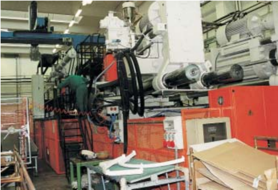
Auch große Seitenteile aus Kunststoff können mit der neuen Spritzgußmaschine hergestellt werden
