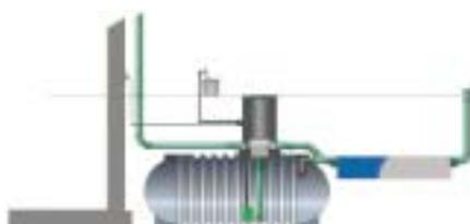
inhaltet alle wichtigen Komponenten, wie Tauchdruckpumpe mit Trockenlaufschutz, Rückflußverhinderer, Rohrverbindungen und Zapfstelle mit Zubehör. Die erweiterbare Versickerungstechnik besteht aus einem Paket von sechs Elwablocksickerspeichern und einem Filterschacht.
