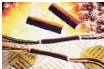
schlauch-Sortiment basiert auf der Entwicklung eines voll flammwidrigen, selbstverlöschenden Heißklebstoffs, der sich außerdem durch Fließfähigkeit, Klebkraft und mechanische Eigenschaften für Versiegelungs- und Schutzzwecke eignet. Wird der Schlauch durch Erhitzen auf den jeweiligen Träger aufgeschrumpft, schmilzt die Kleberbeschichtung und fließt in sämtliche Hohlräume. Dort dichtet sie nach Firmenangaben vollständig gegen Feuchtigkeit, Öle und Chemikalien ab.
