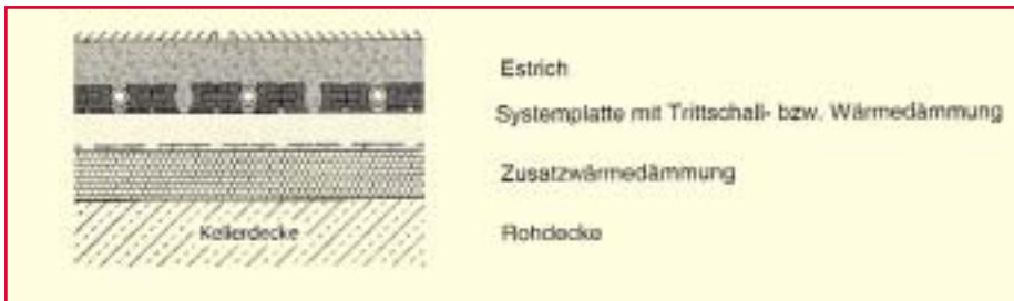
Bild 2 Schematischer Deckenaufbau der Kellerdecke mit Fußbodenheizung (im LV nicht enthalten: Estrich, über 2 cm hinausgehende Zusatzwärmedämmung)
