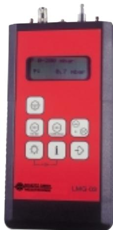
*Mit dem LMG-03 bietet die Schütz-Meßtechnik GmbH einen Leckmessgeräten, der die Leckrate nach dem Durchflußprinzip ermittelt*
