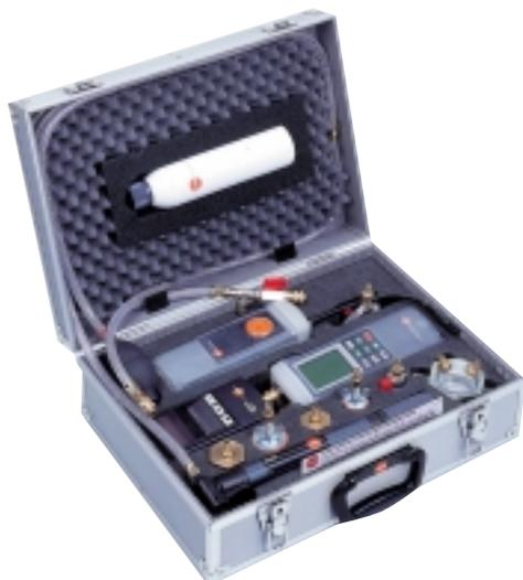
*Beim Testo-Druckprüfsystem wird dem ermittelten Druckabfall in Abhängigkeit vom Leitungsinhalt die Leckmenge über einen Rechenschieber zugeordnet*
