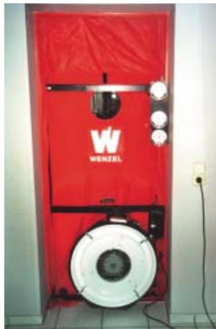
**Die Werotec Blower-Door wird in Tür oder Fenster eingepaßt und erzeugt einen Unterdruck von 50 Pa**
