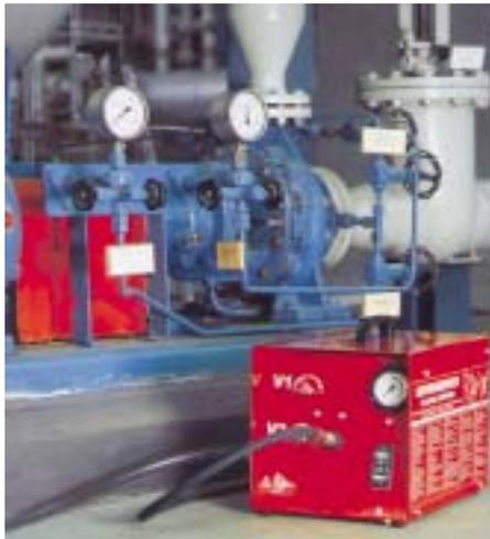
**Die elektrische Prüfpumpe RP 60 E ermöglicht die Dichtheitsprüfung von z. B. Trinkwasserleitungen oder Heizungssystemen**
