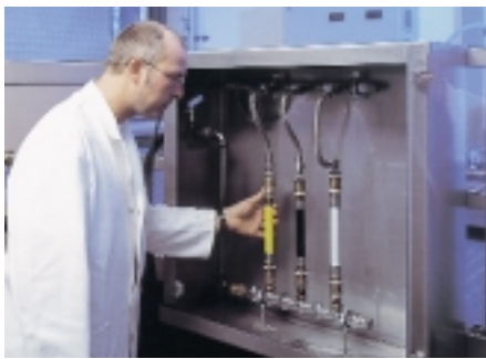
Der Hydro-Pulsator überprüft mit einer Innendruck-Belastung von 40 bar bis zu drei Rohrkörper in 10 000 Druckzyklen auf ihre Dichtigkeit
