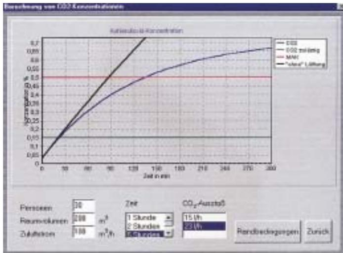
**Berechnung der CO<sub>2</sub>-Konzentration in geschlossenen Räumen mittels Lüftungsplanungs-Software „Lüfter 3“**
