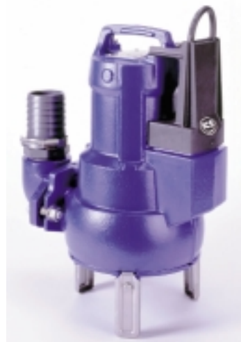
Das schwimmerlose ICS-System mit rechnergestützter Regeleinheit und drei kapazitiven Sensoren befindet sich im Kunststoffgehäuse seitlich an der Tauchmotorpumpe
