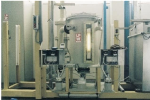
**Die weltweit erste Touch-Free-Beschichtungsanlage ist für eine Kapazität von 50 000 Armaturen jährlich konzipiert**
