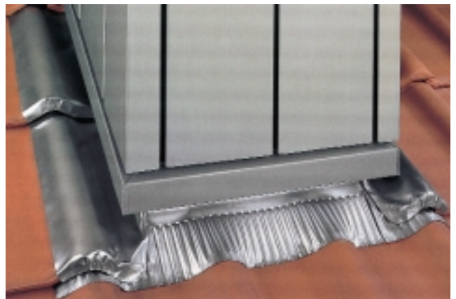
Zur Herstellung der Anschlüsse an Hartbedachungen dient Anformzink, ein flexibles, 0,6 mm dickes Material, das in glatter oder plissierter Form erhältlich ist
