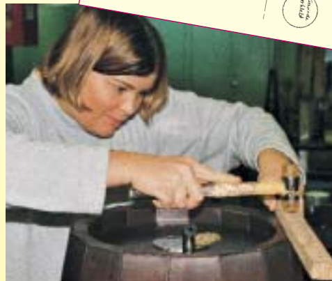
Einpassen des Faßbodens in die „Pseudo“-daubenkonstruktion des Weinfasses
