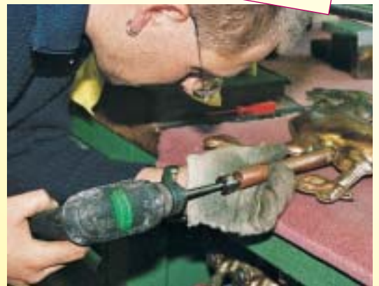
Die kupferne Rohrhülse muß kalibriert werden . . .
