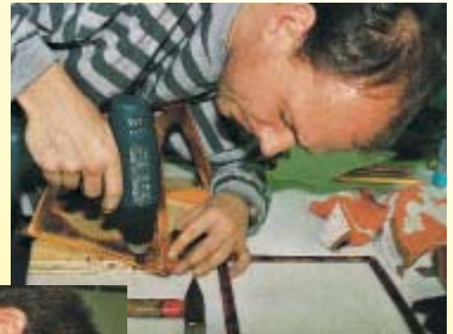
Entgraten der Bohrlöcher für die Zierschrauben
