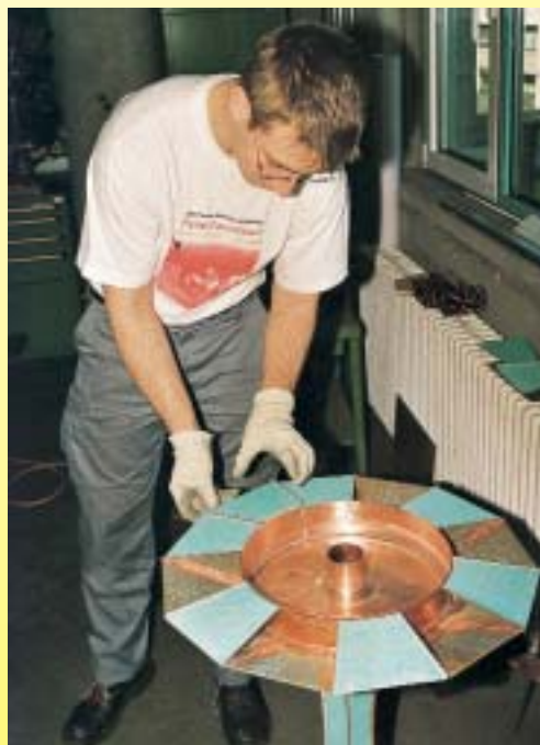
Aufstellen der Stehfälze mit der Sickenmaschine
