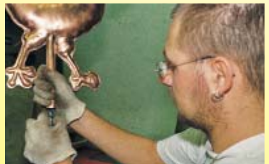
. . . bevor die als Lager dienenden Glaskugeln eingesetzt werden können
