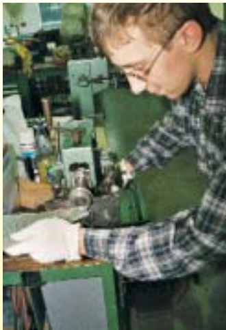
Aufstellen der Stehfälze mit der Sickenmaschine
