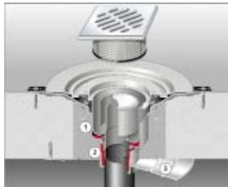
**Mit Viega-Advantix-Montageset aus Stahl (1), Brandschutzmuffe (2) und Schalungsblech (3) können auch Bodenentwässerungen auf R 120 brandsicher ausgeführt werden**
