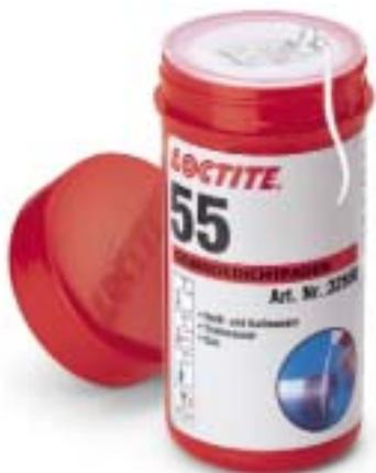
**Das Dichtmittel Loctite 55 ist zugelassen für Gas- und Wasserleitungen bis zu einem Wasserdruck von 16 bar und einer Wassertemperatur von 130 °C**
