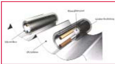
Prinzip des „Sydney“-Vakuümrohrenkollektors
