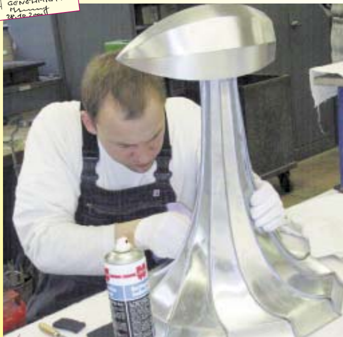
Vor dem Einsetzen des Motors und des Luftschaubenkäfigs wird das Objekt auf Hochglanz gebracht
