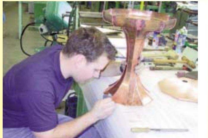
Die Stehfalze an Ziergegenständen aus patiniertem Kupferblech werden meist blank poliert
