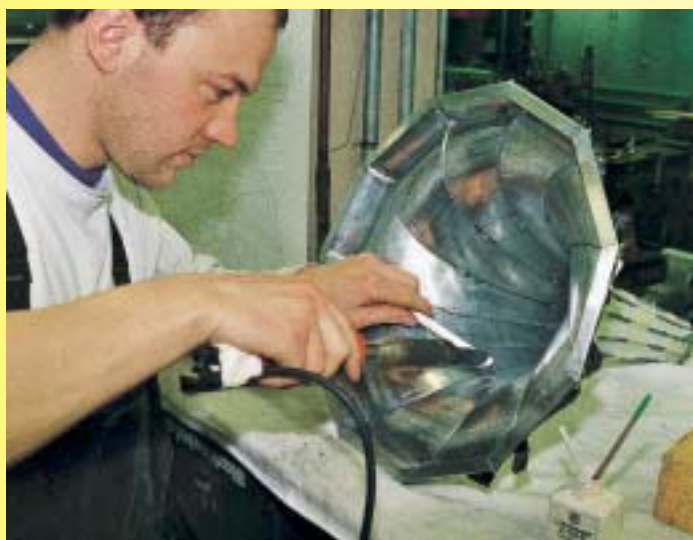
Die Segmente des Grundkörpers sind nach außen gefalzt und innen durch Weichlötheftpunkte gesichert
