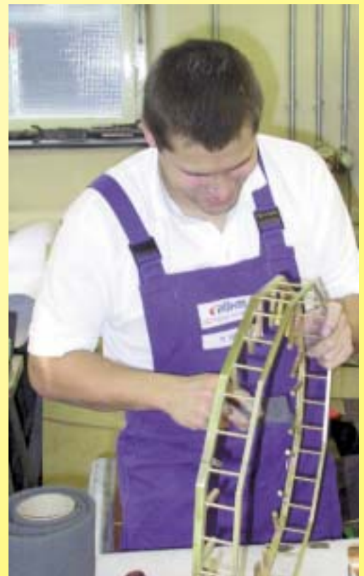
Vorbereiten des Messinggeländers zur Montage
