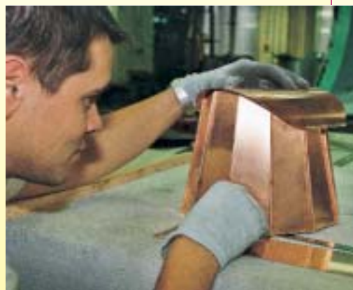
Anpassen der Abdeckung des Windmühlkopfes
