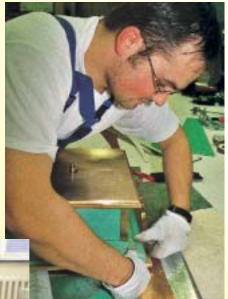
Millimeterarbeit: Das Einpassen des Grundkörpers in die gefrästen Schlitze der Messing-Bodenplatte
