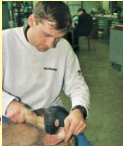
Die Kugelhälften aus Kupferblech werden beim Treiben mehrmals ausgeglüht und abgeschreckt
