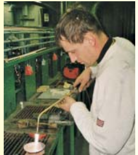
Die Kugelhälften aus Kupferblech werden beim Treiben mehrmals ausgeglüht und abgeschreckt
