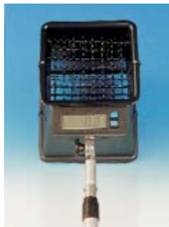
Lüftungsmeßgerät zur Volumstrommessung an Zu- und Abluftöffnungen
