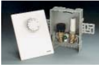
Die Unibox E plus kombiniert Raumtemperaturregelung und Rücklauftemperaturbegrenzung
