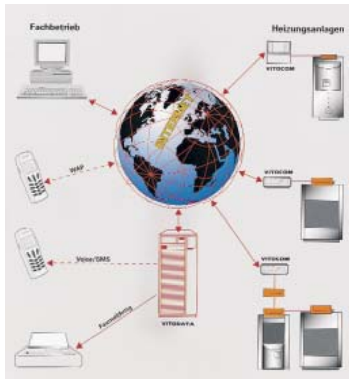
Mit Vitodata stellt Viessmann ein umfassendes Fernüberwachungssystem zur Verfügung.
