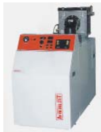
Der Öl-/Gas-Kessel MCHV (Leistungsbereiche 18 bis 32 kW) läßt sich als NT- und mit AWR auch als Brennwert-Kessel betreiben
