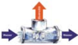
Angetrieben vom Wasserdurchlauf in der Gas-WW-Therme Hydro-Power, produziert die Turbine elektrischen Strom für die Brennerzündung
