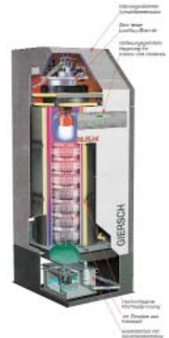
Die Öl-Brennwert-Kompakt-wärmezentrale MultiJet 18 (Nenn-wärmeleistungsbereich 16–18 kW) kommt mit wenig Stellfläche aus
