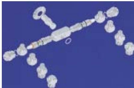
Eckventil in Modulteknik mit zwei einzeln absperzbaren Abgängen
