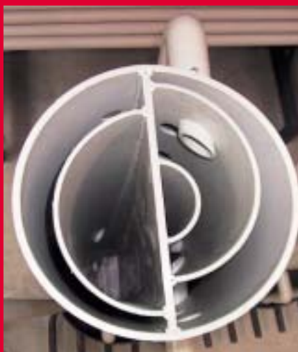
Verwirbelungsfreie Einlagerung von Wärmeenergie
