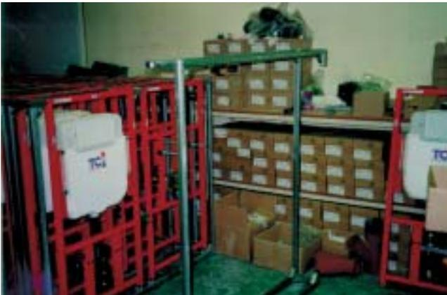
**Die Tece-Gestelle wurden in der Werkstatt mit Profilrohren zu VWI-Rahmen zusammengebaut . . .**
