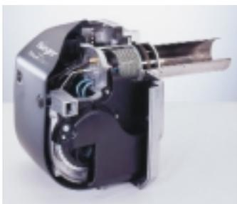
Anbau an alle marktgängigen Heizkessel geeignet ist, erfüllt die Anforderungen des Umweltzeichens „Blauer Engel“ und der Schweizer Luftreinhalteverordnung. Bei der Inbetriebnahme muß der Heizungsbauer lediglich die örtlichen Gegebenheiten überprüfen, da der Brenner bereits im Werk warm geprüft und auf die Brennerleistung eingestellt wurde, wobei eine Anpassung mit wenigen Handgriffen möglich ist.
