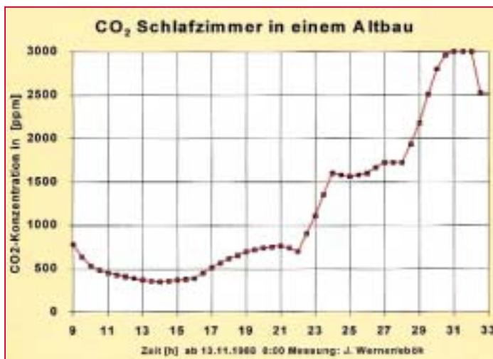
**Bild 3** CO<sub>2</sub>-Konzentrationen, die Johannes Werner unter den im Text genannten Bedingungen in einem 1984 gebauten Haus (kein Niedrigenergiehaus) gemessen hat
