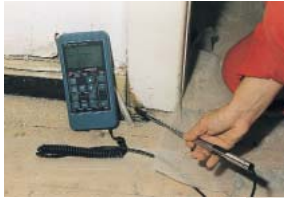
Das thermische Anemometer dienen zur Ortung feinsten Undichtheiten
