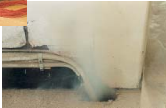
Während der Ventilator der Blower Door in Betrieb ist, kann man mit einem Nebelgerät unklare Leckfaden aufdecken
