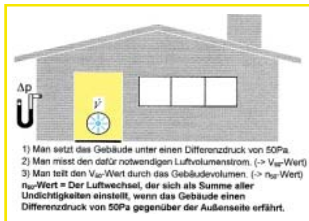
Grundgedanke der üblichen Luftdichtheitsmessung an Gebäuden nach dem sog. Blower-Door-Prinzip: Erzeugung eines definierten Differenzdruckes zwischen der Gebäudeinnenseite und der Umgebung
