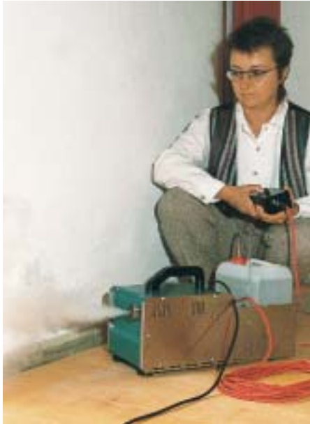
Während der Ventilator der Blower Door in Betrieb ist, kann man mit einem Nebelgerät unklare Leckfaden aufdecken
