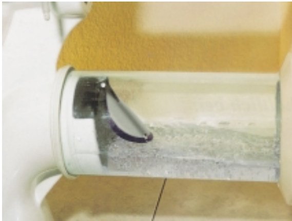
Die Klappe öffnet sich durch den Spülwasserdruck und schließt sich automatisch durch die eingebaute Edelstahlfeder
