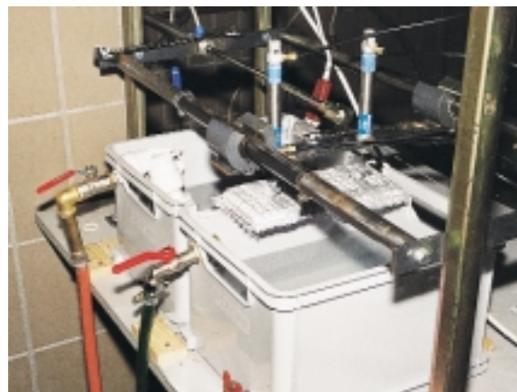
Im Test werden die Proben abwechselnd 10 000 mal in kaltes und heißes Wasser eingetaucht. Danach folgt die Abriebprüfung
