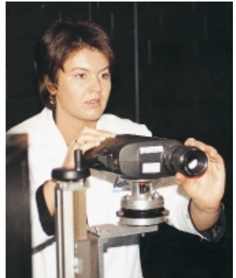
Die Farbgleichmäßigkeit wird mittels Spektralphotometer bestimmt
