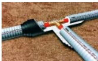
Biegeradien, so daß Rauthermex an nahezu jede Trassenführung angepaßt werden kann. Die Verbindung der Medienrohre erfolgt mit Schiebehülsen, die Verbindung der Dämmungsschicht an den Abzweigungen und sonstigen PE-Xa-Rohrverbindungen mit einer sogenannten Universal-muffe. Letztere ist für mehrere Durchmesser einsetzbar.
