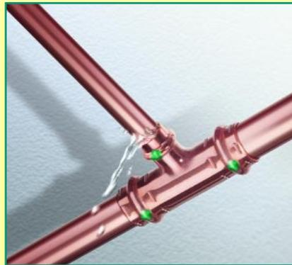
Mehr Sicherheit bringt die neue Kontur der Viega-Preßtechnik. Die Attendorner schufen eine neue Generation Preßfittings, die grundsätzlich undicht sind, sollten sie versehentlich mal nicht verpreßt werden
