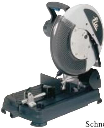
Schnellspann-Vorrichtung gespannt. Eine zusätzliche, serienmäßig mitgelieferte Vertikal-Spannklammer hilft, große Profile sicher zu halten.
