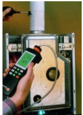
hindert die Verfälschung der Meßwerte durch die NO-Querempfindlichkeit. Zur genaueren Meßwertbestimmung trägt weiterhin bei, daß in der Sammelblase der Abgassonde automatisch ein Mittelwert gebildet wird. Der Infrarotdrucker protokolliert die Meßdaten.
