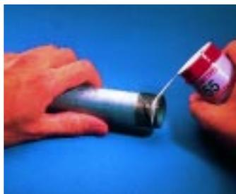
gen. Zum Abschneiden des Fadens befindet sich an der Oberseite der Dose eine integrierte Schneidklinge. Aus einer Dose mit 150 m Inhalt lassen sich z. B. etwa 260 Verbindungen von Rohren mit DN 20 abdichten. Nach der Montage sind die Verbindungen sofort dicht und voll belastbar. Auch nach der Montage bleibt die Verbindung bei Erhalt der Dichtwirkung justierbar. Das Produkt entspricht der
