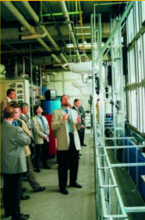
Im Labor der Abteilung Versorgungstechnik erläuterte Prof. Schmickler die Versuchsanlage, an der die Wissenschaftler Spülversuche mit verschiedenen Rohrweiten, Gefällen und Spülwassermengen durchgeführt haben...
