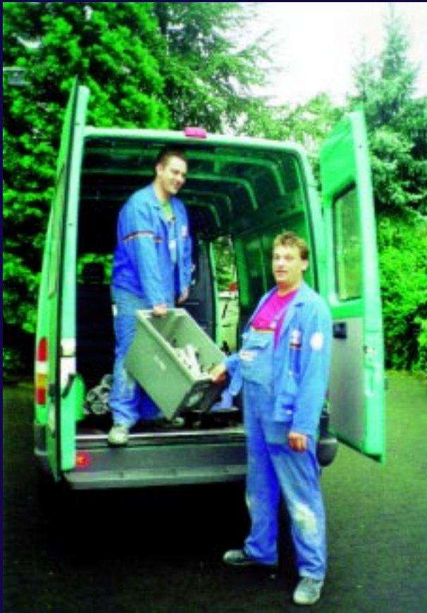
Praktische Hilfe: Gerade beim Be- und Entladen sperriger oder schwerer Güter waren die SHK-Handwerker froh über die zusätzliche Trittstufe am Heck des Sprinters
