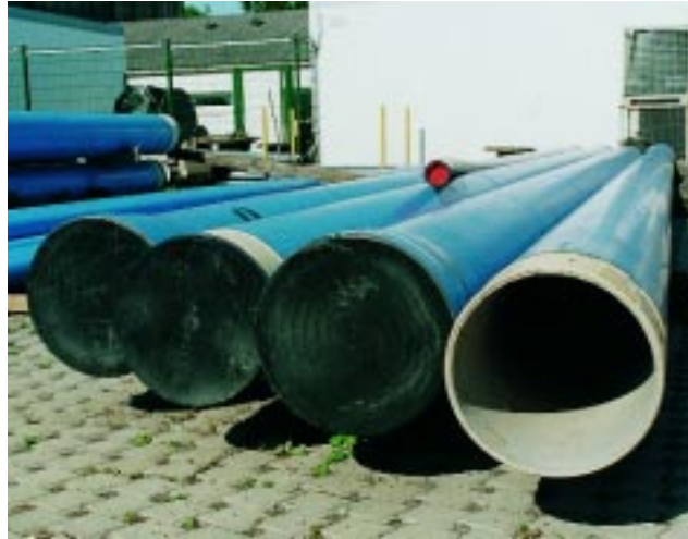
Heute dient eine Zementmörtelauskleidung als Korrosionsschutz in Trinkwasserversorgungsleitungen; innengeteerte Rohre werden seit 1970 nicht mehr verwendet
