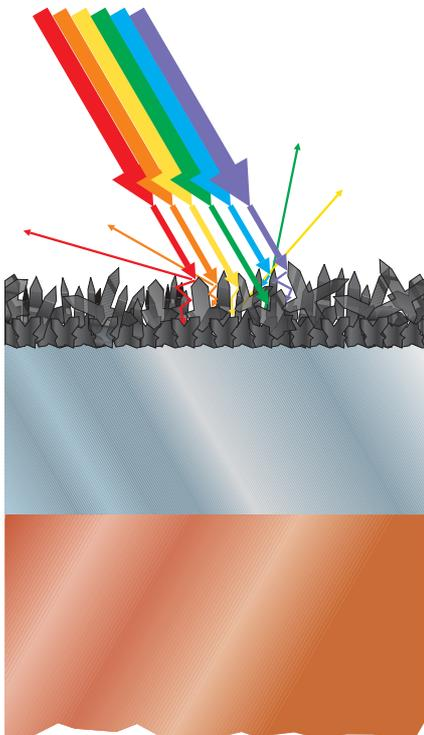
**Bild 8** Lichteinfall und Absorption auf eine poröse Oberfläche „Verschlucken“ der Lichtanteile in der porösen Deckschicht
