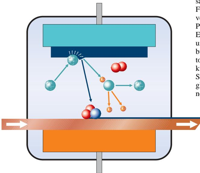
**Bild 10 Schematische Darstellung des Sputterns nach Interpane**
