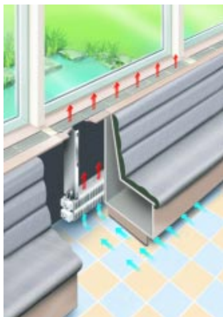
Bild 8 Konvektor hinter einer Sitzbank
