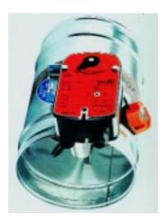
schosse übertreten. Mit motorisierten Absperrvorrichtungen der Serie FKRS von Trox läßt sich das verhindern. Über Rauchmelder zur Raumüberwachung angesteuert, schließen sie bei Rauchdetektion automatisch. Der Leckvolumenstrom bei geschlossener Klappe beträgt weniger als 0,5 m³/h.
