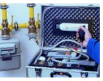
kleine Leckstellen in Gasleitungen auf. Der Grad der Gebrauchsfähigkeit der Gasleitung ermittelt der Installateur auf dem mitgelieferten Rechenschieber. Die Bestandteile des Prüfsystems sind aus robusten Materialien hergestellt. Über Steck-
