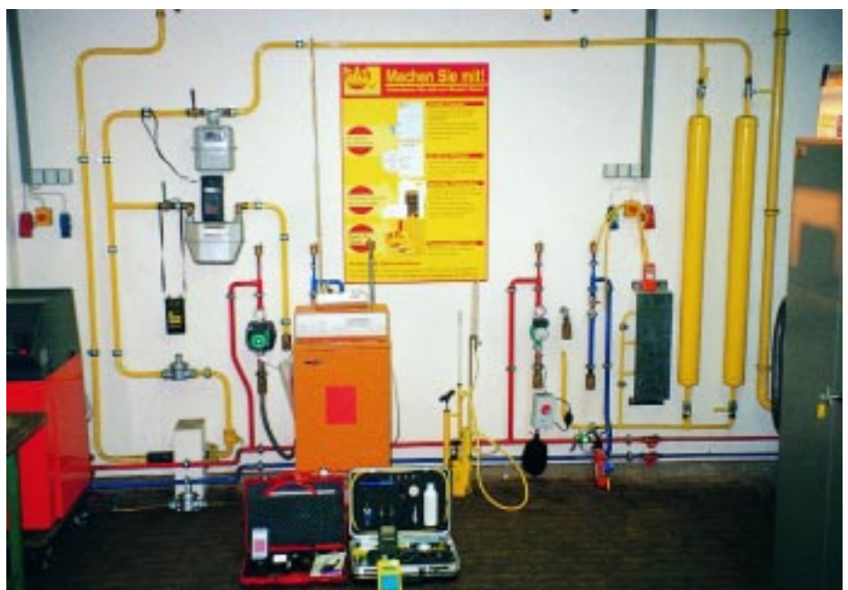
Die Trainingswand ermöglicht es, verschiedene Leitungsvolumen zu simulieren. Der Teilnehmer lernt so, die Meßergebnisse zu bewerten
