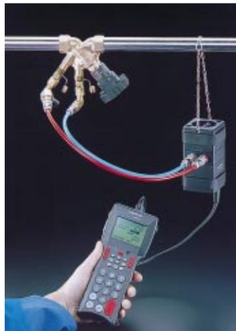
verarbeitet werden. Der Meßbereich reicht von  $-0,05$  bis 200 kPa, der Temperaturmeßbereich von  $-20$  bis  $120$  °C. Zur besseren Handhabung ist der Nullabgleich automatisiert.
