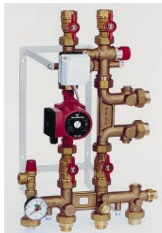
Bauteil zusammengefaßt. So sind Heizungsumwälzpumpe, 3-Wege-Umschaltventil, Überströmventil und Absperrarmatur auf einem Abstandhalter angebracht, der über der Wärmepumpe an die Wand geschraubt wird. Die Anschlüsse fluchten genau mit denen der Wärmepumpe, so daß die Anschlüsse nur noch verschraubt werden müssen. Der Pufferspeicher Vitocell 050 wird direkt an die Divicon angeschlossen.
