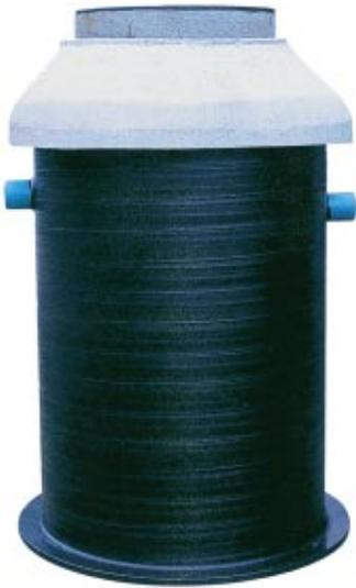
Der Einbau ist kostengünstig, da das Gerät leichter als Stahlbeton ist und weniger Erdaushub anfällt. Außerdem ist der Werkstoff Polyethylen resistent gegen Fettsäuren von innen und aggressive Wässer und Böden von außen. Die handelsüblichen Schachtaufbauteile aus Stahlbeton können bauseitig gestellt werden.
