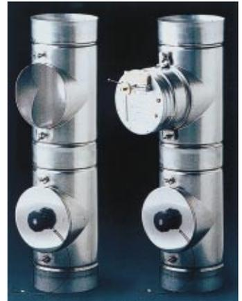
hält neben Komponenten wie Kondensatabscheider und verstellbarer Vier-Segment-Bogen auch ein T-Stück, daß mit einem Deckel versehen als Reinigungsverschluß dient. Durch einen Adapter kann es aber auch mit einem Zugbegrenzer der Typen Z 130 oder ZUK 130 ausgestattet werden. Das erspart aufwendige Schneidarbeiten vor Ort. Die Verbindungsleitung ist in Durchmessern von 110 bis 180 mm erhältlich.
