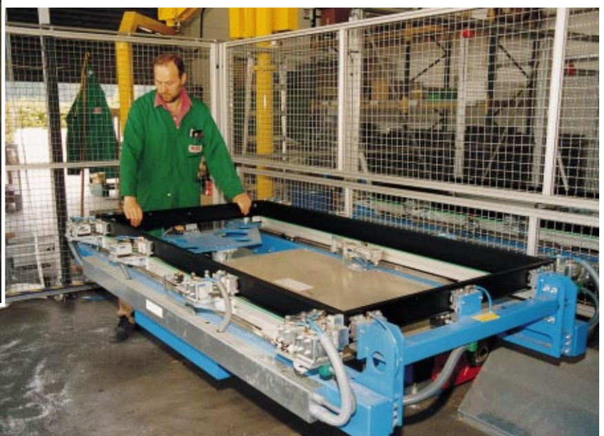
Solar-Fertigungsleiter Gerhard Spanner demonstriert hier, wie die Profile des Flachkollektorrahmens in den Drehtisch eingelegt werden
