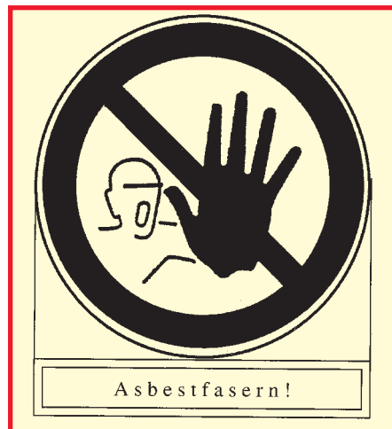
Bild 1 Verbotsschild nach UVV „Sicherheitskennzeichnung am Arbeitsplatz“ (min. Durchm.: 0,4 m)
