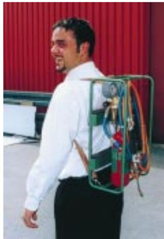
Schutz der Absperrventile. Im Tragegestell ist eine Propangasflasche mit 0,425 kg sowie eine Sauerstoffflasche mit 2 l Inhalt, versehen mit Propan-Konstantregler und Sauerstoff-Druckminderer, untergebracht. Die Schläuche sind zwei Meter lang, das Griffstück ist mit einem Hartlöteinsatz für die Materialstärken 2 – 4 mm ausgestattet.
