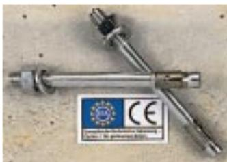
Federpaket und spreizen nach, sobald Risse im Beton auftreten. Den Exa-CT gibt es vorerst in galvanisch verzinkter Ausführung in den Größen von M8 bis M16. Als Durchsteckanker, bei dem Anker- und Bolzendurchmesser identisch sind, eignet er sich für schnelle Reihenmontagen. Die Anker werden mit vormontierter Scheibe und Mutter ausgeliefert.
