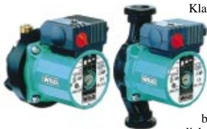
höhe und 150 l maximaler Fördermenge die Ansprüche einer sogenannten Low-Flow-Solaranlage. Die Variante ST 25 fördert bis zu 3000 l maximal sieben Meter hoch und ist somit für größere High-Flow-Anlagen mit Kollektorflächen bis 70 m<sup>2</sup> ausgelegt. Beide Pumpen verbrauchen bis zu 30 % weniger Strom als vergleichbare Heizungs-Umwälzpumpen.
