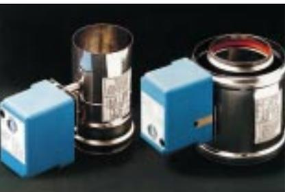
den direkt nach dem Abgas- bzw. Luft-Abgas-Stutzen des Gerätes eingebaut. Erst bei Wärmeanforderung erhält der Stellantrieb der Abgasklappe Strom und öffnet sie. Die Schließstellung des Absperrteils ist von außen sichtbar. Die Absperrgeräte gibt es sowohl für raumluftabhängig betriebene Gasfeuerstätten (Bauart B) als auch für raumluftunabhängige (Bauart C). Der Einsatz in Abgasanlagen für Unterdruckbetrieb ist ebenfalls möglich.
