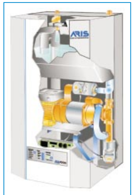
Die Regenwasserzentrale enthält die gesamte Versorgungseinheit der Trinkwassernachspeisung, Steuerung und Druckerhöhung
