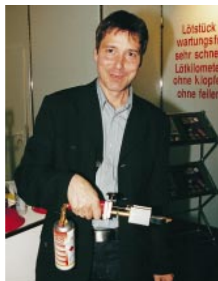
Der LötKolben mit beweglicher Gaskartusche von Adi Marini ist für das Löten in allen Lagen geeignet und durch seine Gestaltung lange Zeit ohne Ausschmieden nutzbar
