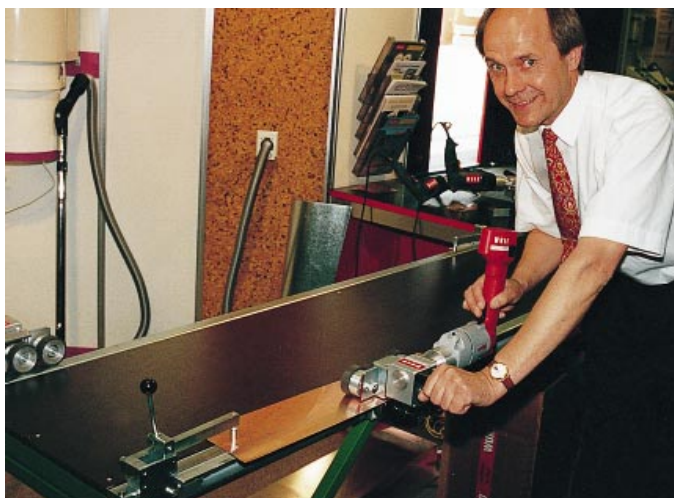
Peter Wukovich ließ es sich nicht nehmen, seinen für die Baustelle gedachten akkubetriebenen Rolenschneider – beispielsweise für konische Scharen – selbst vorzuführen
