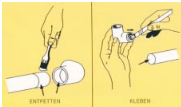
Bei Verwendung moderner Kunststoffkleber ist bereits zwei Stunden nach dem Verkleben die Benutzung der Anlage möglich
