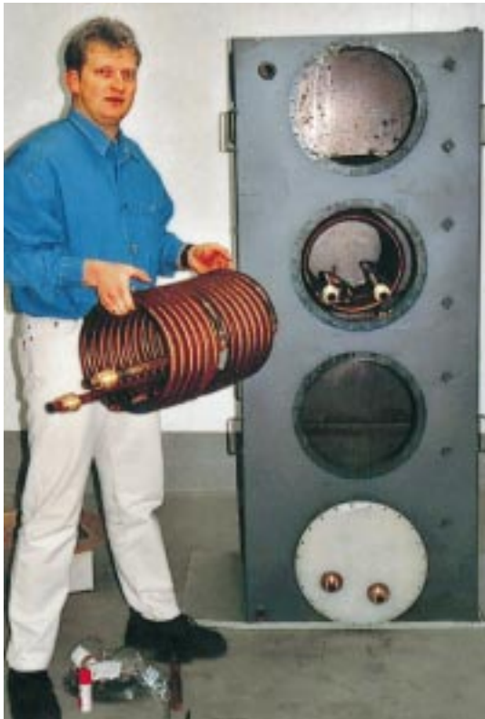
Kernstück für die ganzjährige Nutzung der Solarenergie sind die mit Wärmetauschern ausgestatteten fünf Speichermodule mit einem Gesamtfassungsvermögen von 10 000 Litern
