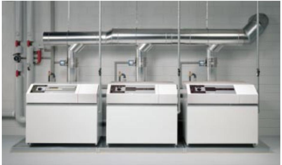
**Die Großkesselserie „Supramax“ mit atmosphärischem Brenner ohne Gebläseunterstützung gibt es in vier Leistungsklassen ab 144 kW bis zu einer Gesamtleistung von 918 kW in Kaskadenschaltung**
